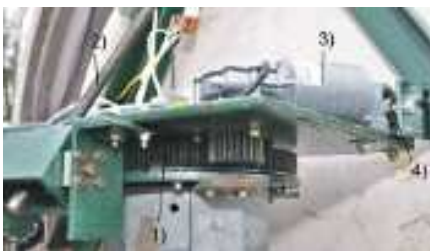
Abb. 3: Azimutantrieb. 1) großes Ritzel; 2) Gewindestange Elevationsantrieb; 3) Antriebsmotor; Antrieben 4) Schwenkachse Elevationsantrieb
