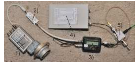
Abb. 5 : Messstrecke: 1) LNB; 2) LNA; 3) SAT-Finder; 4) USB-Interface; 5) Bias-T
