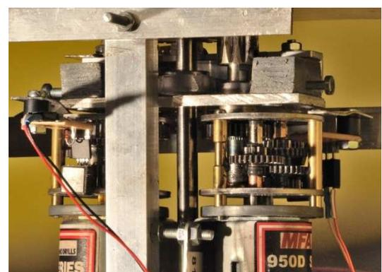
Abb. 6: Der Getriebekopf mit Magnetsensor
