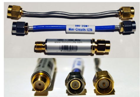
Abb. 1: Semi-Rigid-Leitungen und Bandpassfilter mit SMA-Stecker und Buchse
