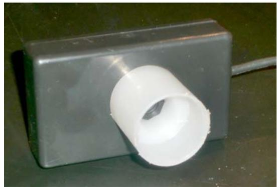
Abb. 9: Webcam mit Steckaufsatz
