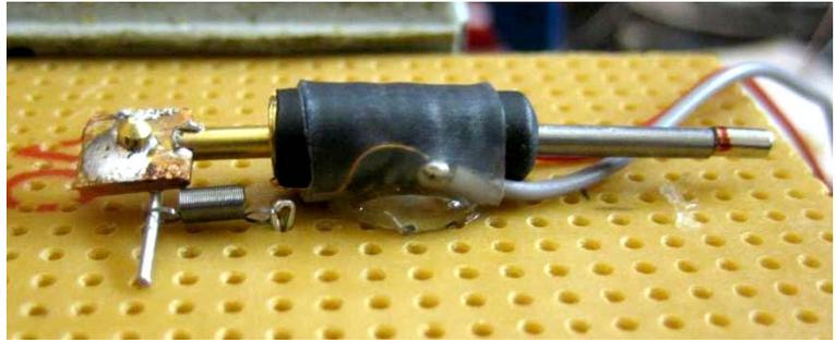
Abb. 9: Probeaufbau mit Spule und Braillepunkt
