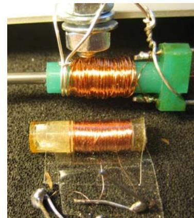
Abb. 8: Vergleich der Spulen (oben: 0,15 mm, unten: 0,05 mm Drahtdurchmesser)
