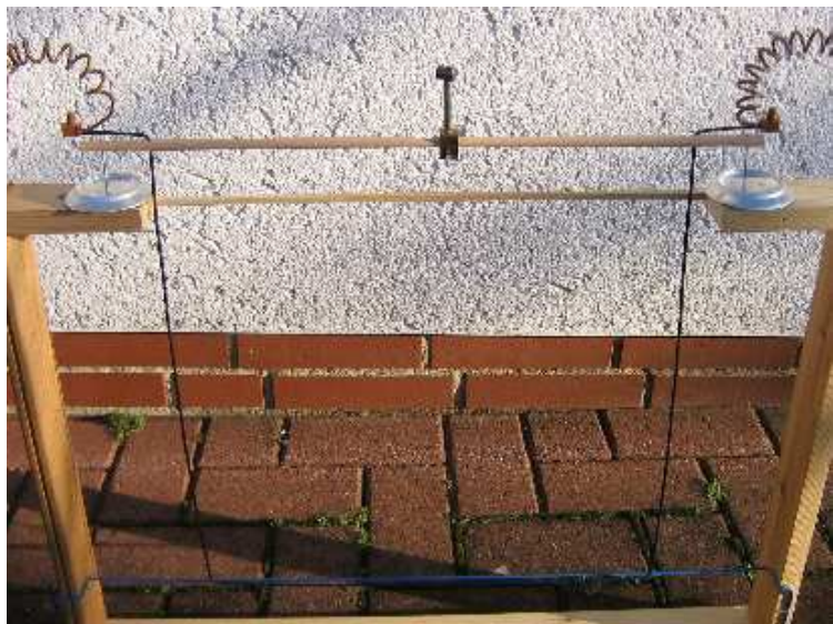
Abbildung 5: Die Schaukel mit klassischer Aufhängung und die flexible Verbindung
