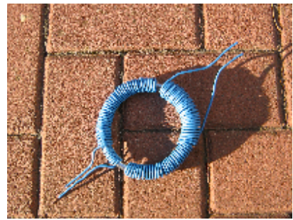
Abbildung 7: Der Ring, links die Primärwindung, rechts die Sekundärwindung
