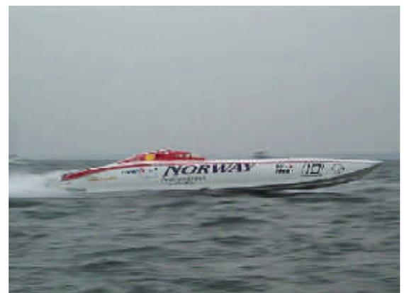
Abb. 4: Rennboot als Beispiel für ein Schiff mit Gleitrumpf
