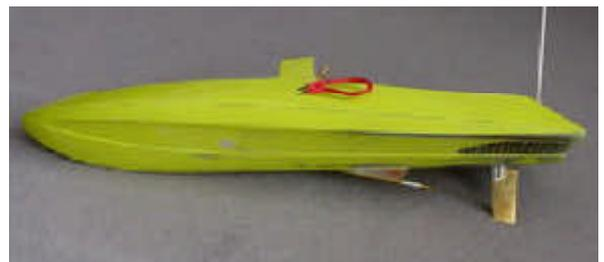
Abb. 9: Voll eingetauchte Schraube - die Welle ist tief unter der Rumpfmittle angeordnet [3]
