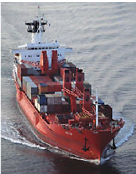
Abb. 3: Containerfrachter als Beispiel für ein Schiff mit Verdrängerrumpf [1]
