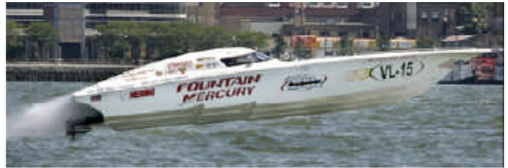
Abb. 5: Ein gestufter Rumpferleichtert das Ablösen des Rumpfes von der Wasseroberfläche. [2]
