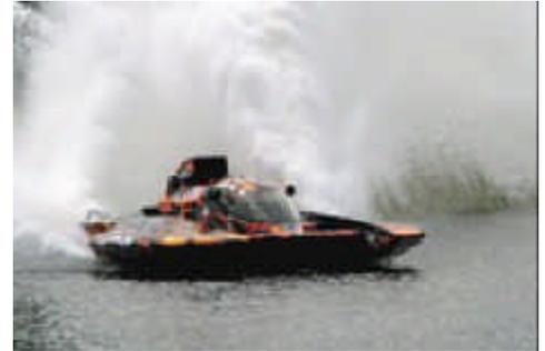
Abb. 8: Dreipunktgleitmodell - die Kabine befindet sich auf dem mittleren Hauptrumpf [8]
