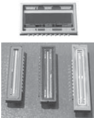
Abb. 7: Varianten verschiedener CCD's, oben ein Flächensensor; darunter drei Single-Line-CCD's, davon ganz rechts ein Farb-CCD
