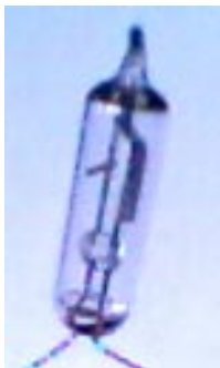
Abb. 2: Eine Glimmlampe (Länge: 25mm)
